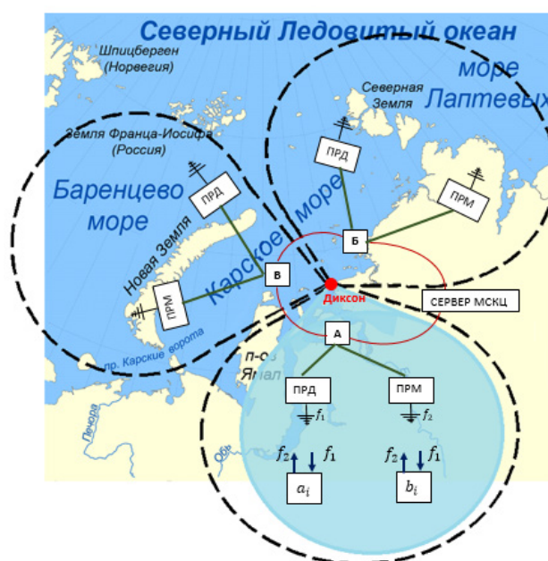
Рис. 1. Топология варианта телекоммуникационной сети обмена данными на примере морского спасательно-координационного центра (МСКЦ) в городе Диксон
