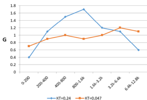
Рис. 8. Зависимости взвешивающей функции G от полосы частот и коэффициента тональности сигнала.
