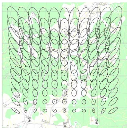
Рис. 1. Иллюстрация оценки точности ОМП ИРИ наземными средствами радиомониторинга
