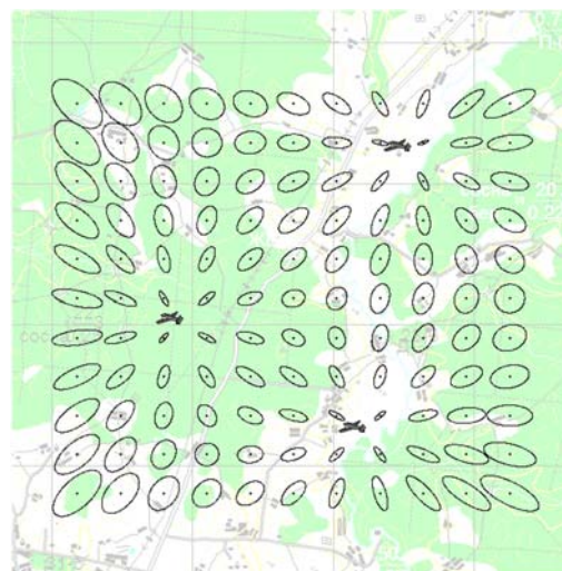
Рис. 2. Иллюстрация оценки точности ОМП ИРИ воздушными средствами радиомониторинга
