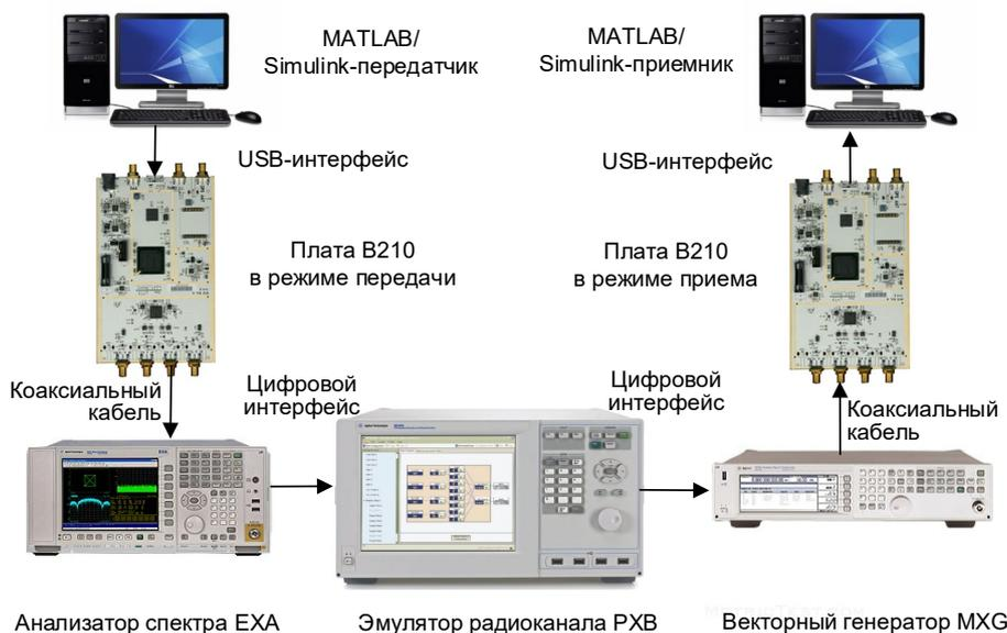
Рис. 18. Структурная схема стенда Keysight СПбГУТ
