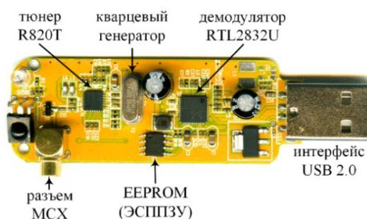
Рис. 9. Основные микросхемы приемника RTL-SDR (NooElec)
