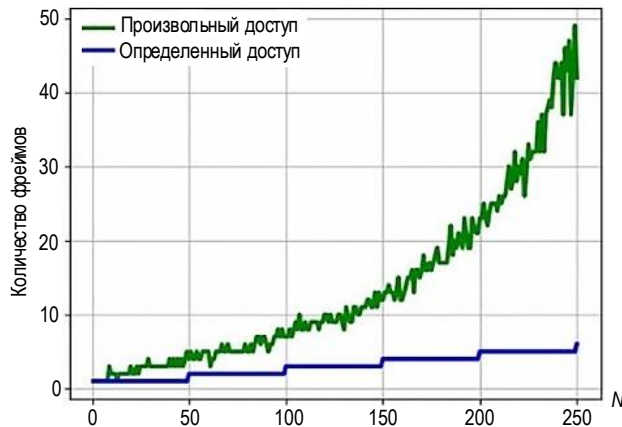
Рис. 5. График зависимости количества фреймов, требуемых для входа N терминалов
