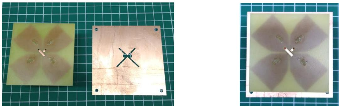
**Рис. 16. Внешний вид экспериментального образца элемента антенной решетки**
