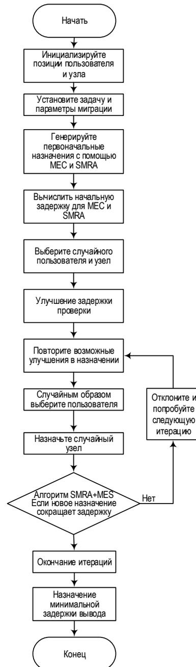
Рис. 2. Структура итеративной модели назначения граничных узлов алгоритма
