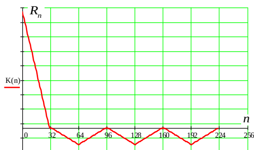
Рис. 3. Корреляционная функция импульсной последовательности 7-элементного кода Баркера
