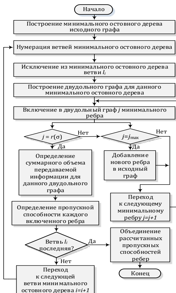
Рис. 9. Блок-схема методики расчёта потоковой структуры сети передачи информации контроля и управления сети ТСС на основе метода сечений
