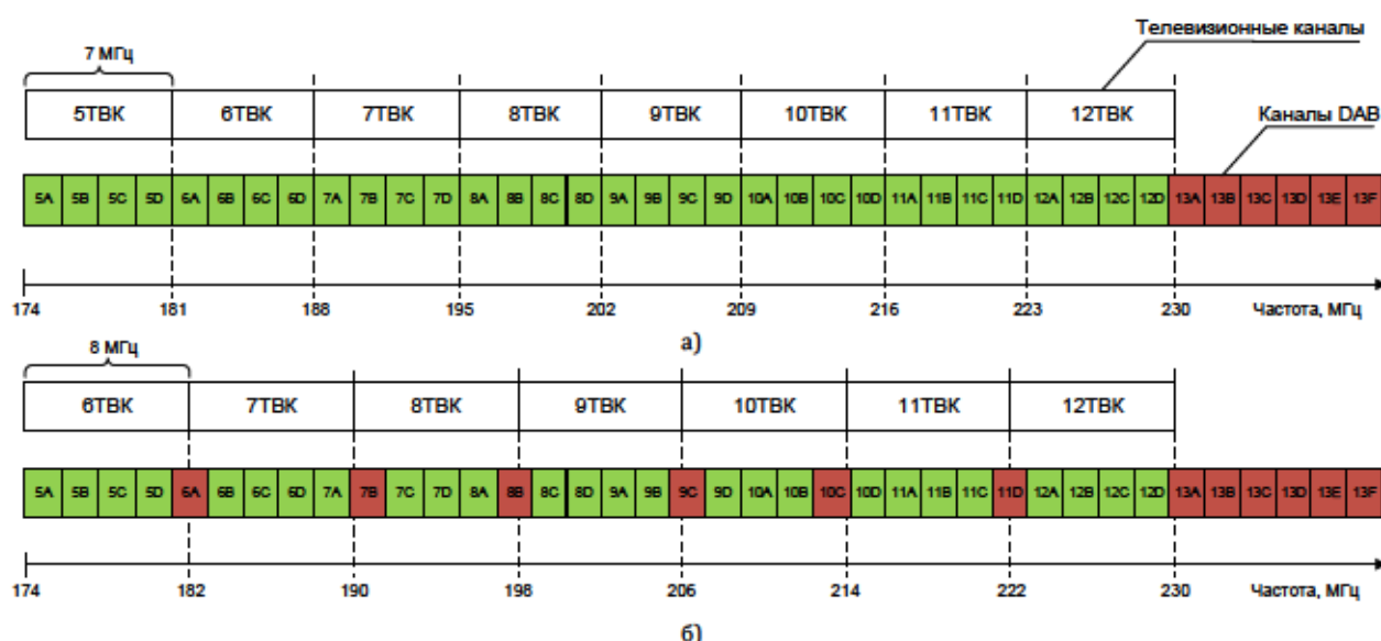
Рис. 2. Размещение каналов DAB в каналах телевидения с учетом европейской (7 МГц) и российской (8 МГц) сетки частот
