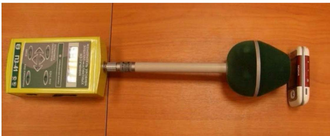
Рис. 2. Измеритель уровней электромагнитных излучений
