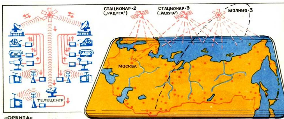
Рис. 4. Система спутниковой связи «Орбита»
