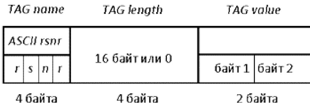
Рис. 2. Структура TAG элемента отношение сигнал/шум протокола RSCI
