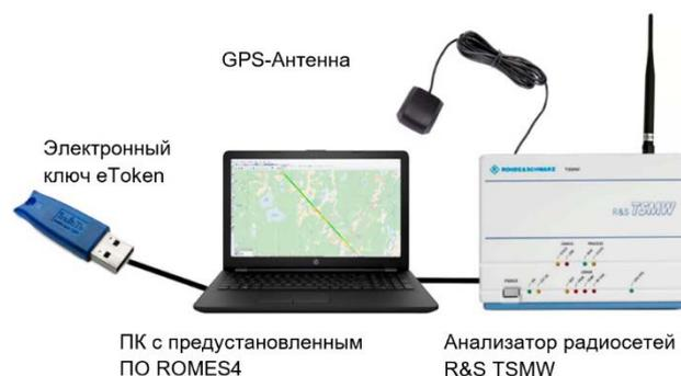
Рис. 2. Схема измерительного комплекса сети TETRA
