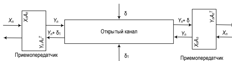
Рис. 2. Модель системы и обмена данными по каналу с помехами
