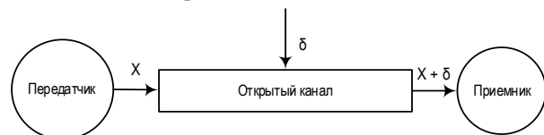
Рис. 1. Упрощенная модель передачи данных по каналу с помехами
