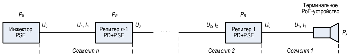
Рис. 4. Структура линии с несколькими репитерами и схема нумерации репитеров и сегментов, принятая в данной статье Fig. 4. Line Structure with Multiple Repeaters and the Numbering Scheme for Repeaters and Segments Adopted in this Paper
