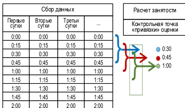
Рис. 6. Схема объединения локальных оценок, полученных на отдельных интервалах интегрирования T_i , в соответствии с предлагаемой методикой
