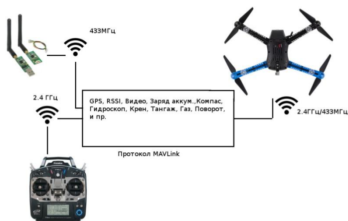
Рис. 1. Схема управления БПЛА типового квадрокоптера с полетным контроллером Pixhawk
