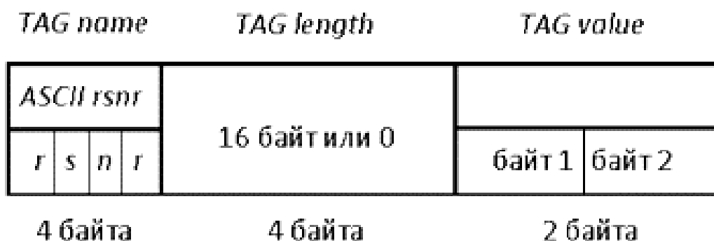
Рис. 2. Структура TAG элемента отношение сигнал/шум протокола RSCI
