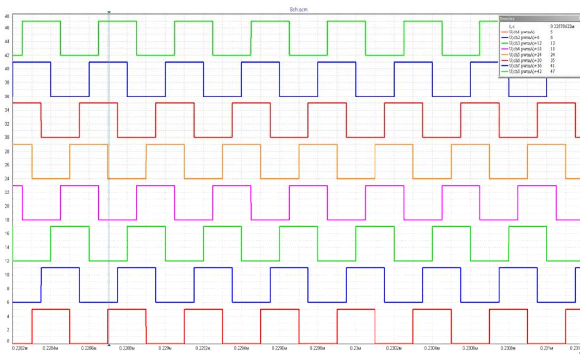
Рисунок 4. Временная диаграмма импульсов при многоканальной (8-канальной) ШИМ
