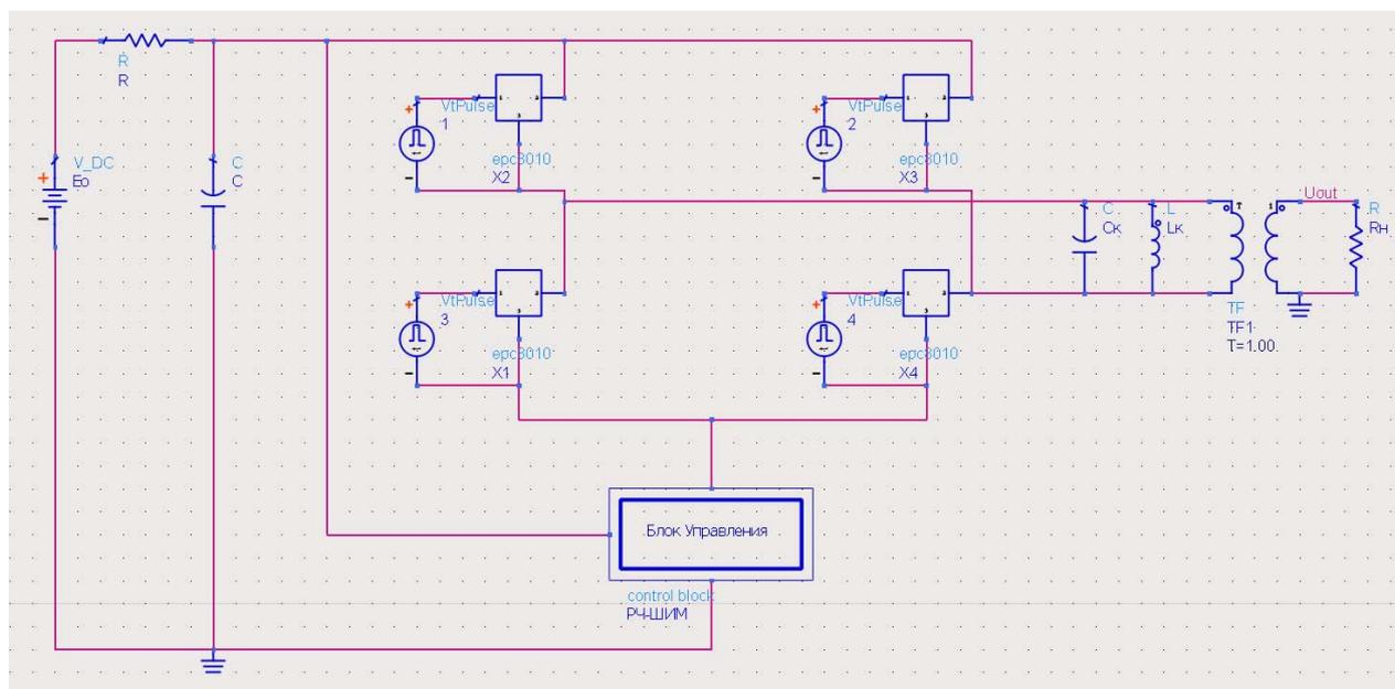
Рисунок 2. Обобщенная модель управляемого РИТ
