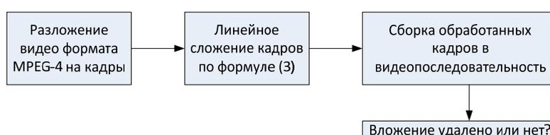
Рисунок 1. Общая схема реализуемого алгоритма фильтрации видеопоследовательностей
