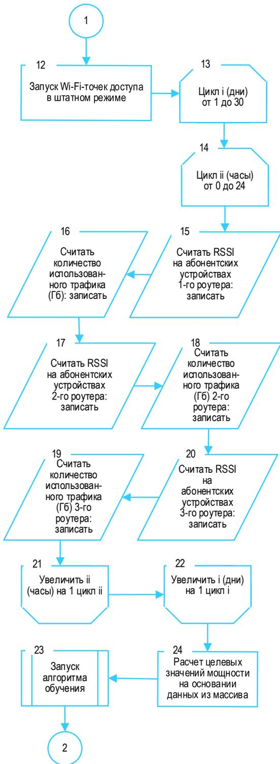
Рис. 2. Алгоритм включения  $AP_k$  в штатном режиме, фиксация трафика
