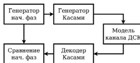
Рис. 4. Модель системы передачи с каналом ДСК
