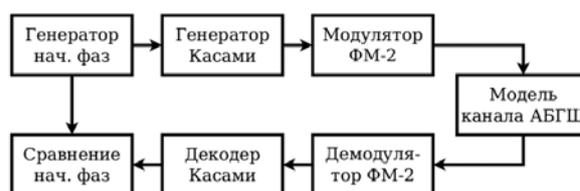
Рис. 5. Модель системы передачи с каналом АБГШ и манипуляцией ФМ-2
