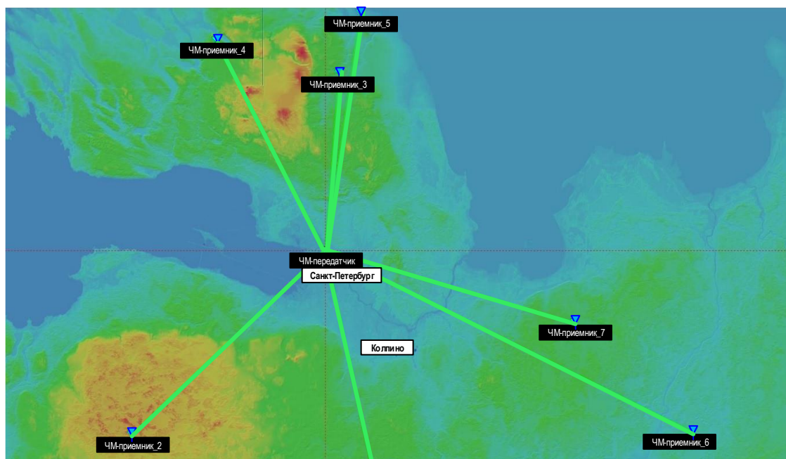
Рис. 3. Карта местности с показом расположения мест передающей и приемной станций для последующего расчета зон покрытия для выбранных радиальных направлений
