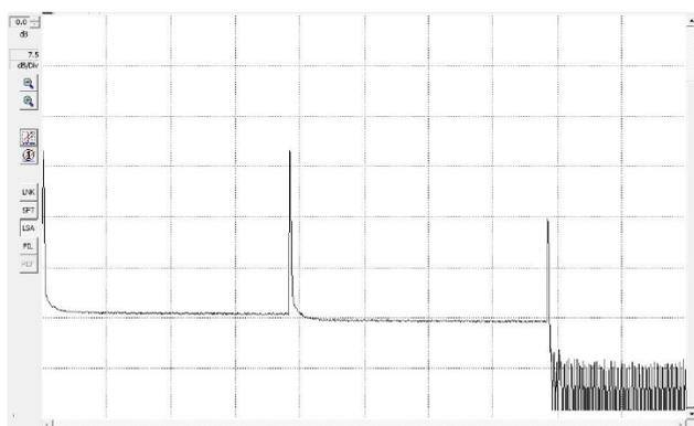
Рис. 9. Рефлектограмма макетной линии
