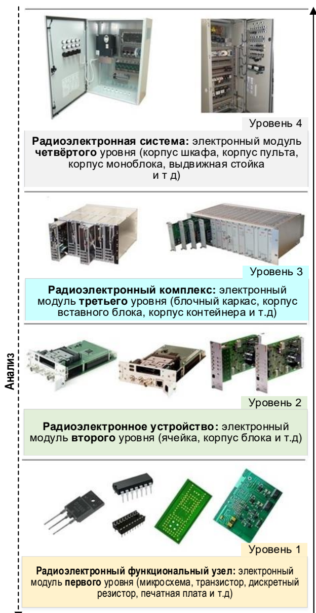
Рис. 1. Уровни разукрупнения радиоэлектронных средств по конструктивной и функциональной сложности
